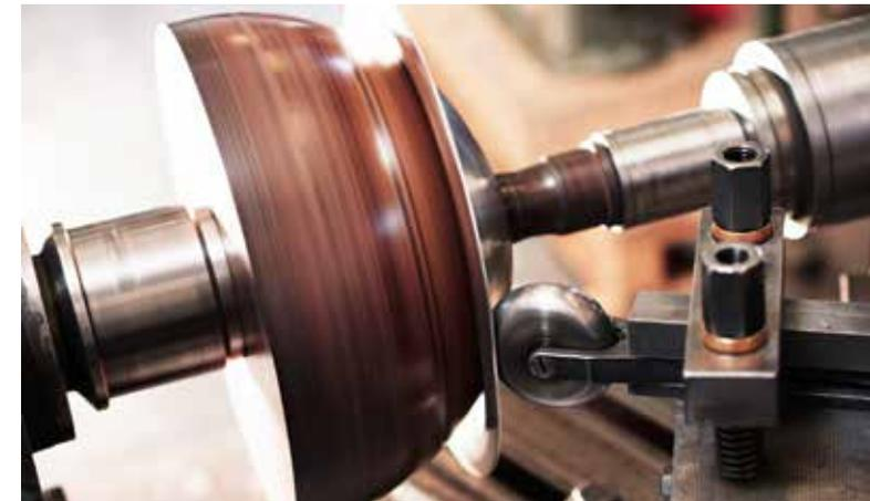
Abb. 13\_ Metalldrückverfahren
